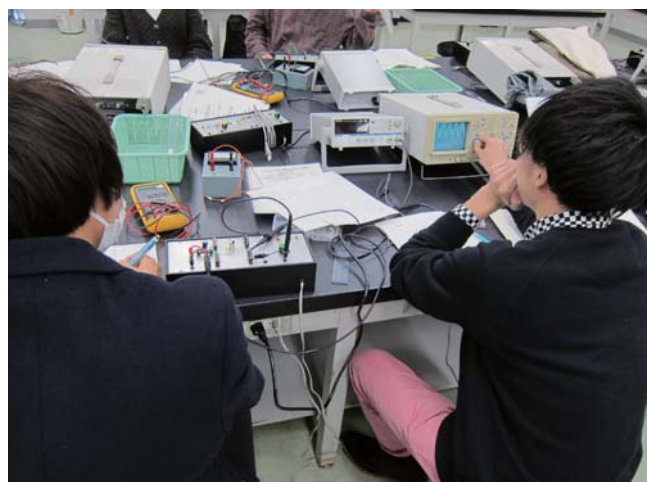
写真2：トランジスタ回路を組み立て オシロスコープで増幅作用を観測
