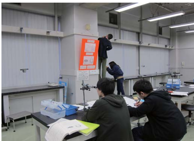
写真1：望遠鏡をのぞきながら、ねじれ振り子の周期を測定 右奥では針金の長さを測定中
