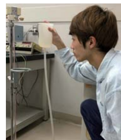
写真1: 共鳴する水面の高さを測定する
