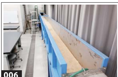
水流による砂の流れ方や堆積の仕方から地層を調べる循環式実験水路。
