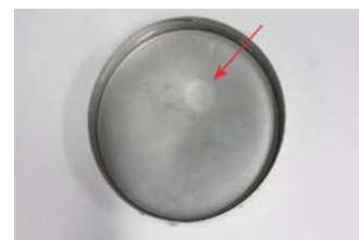
写真2: 水面上に形成されたステアリン酸の単分子膜(矢印の部分)
