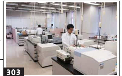
紫外可視分光光度計や赤外分光光度計などの分光装置が配置された測定実験室。
